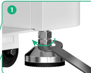
確定機器的放置位置後，①用扳手分別鬆開四個腳座的第二個螺帽。
