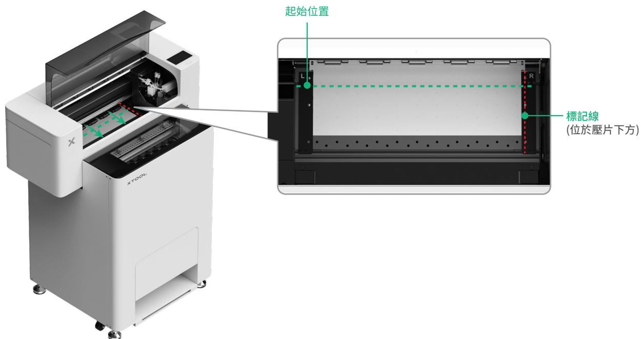
調整兩側壓片的位置,以蓋住 xTool 衣物印刷機膠膜
